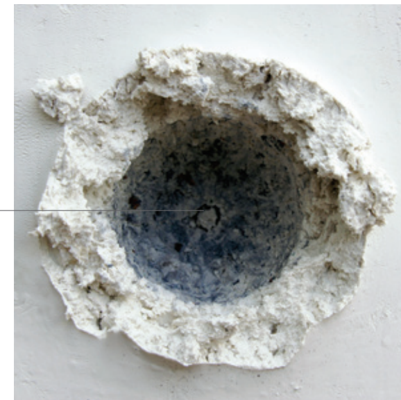
Ensaio balístico realizado em plastilina.
